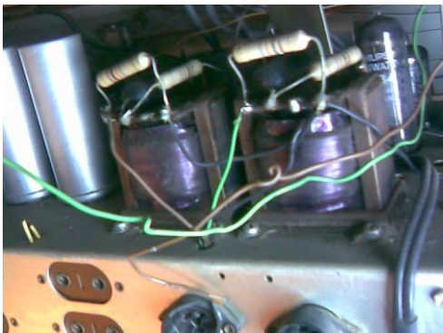
Op de UGT's de weerstanden en condensator vervangen.
