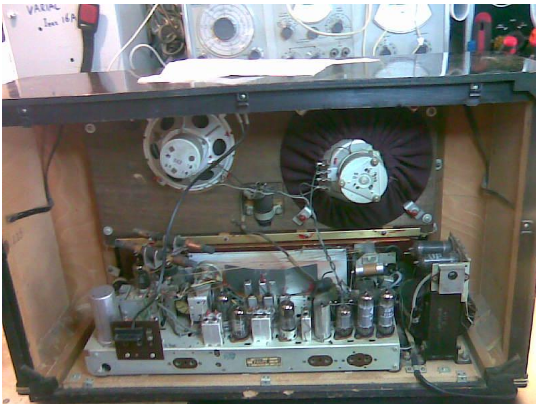
De binnenzijde. Het chassis vertoont grote gelijkenis met soortgelijke BI-Ampli modellen die Philips heeft geproduceerd. Aan deze radio is nog niet eerder gesleuteld en alles ziet er origineel uit.
